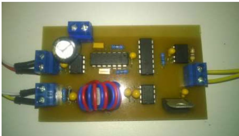
4. attēls. Gatavā IGBT draivera plate
