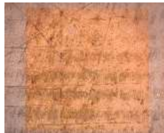
q=1,71 \cdot 10^6 W/cm 2 , v=100 mm/s f=500 kHz, dx=0,01 mm
