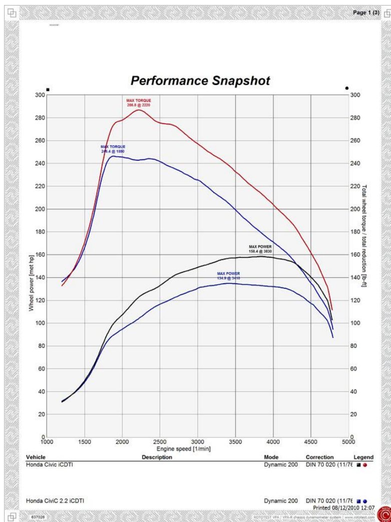
1. attēls. Civic 2.2 i-CDTi jaudas un griezes momenta izmaiņas pēc ECU pārprogrammēšanas [5]
