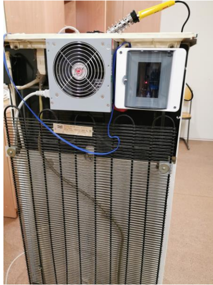
6.attēls. Ledusskapja aizmugure ar mikrokontrolleri
