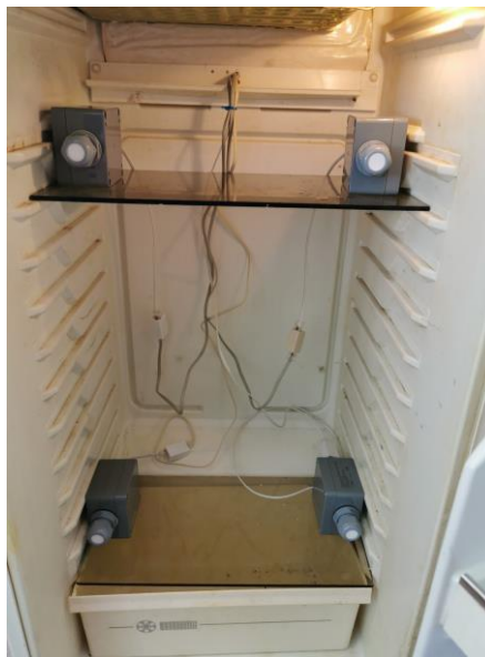
7.attēls. Ledusskapja iekšpuse ar sensoriem
