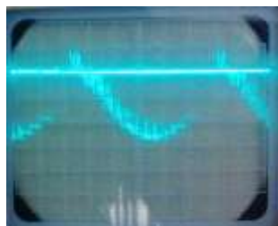
5.attēls Sprieguma izmaiņas oscilogramma, mikrosoļu režīms 1/16
