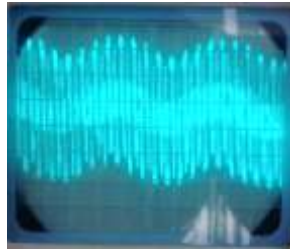
2.attēls Sprieguma izmaiņas oscilogramma, mikrosoļu režīms 1
