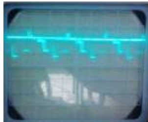
3.attēls Sprieguma izmaiņas oscilogramma, mikrosoļu režīms 1/2
